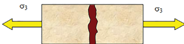
Hình 6. Mô tả phá hủy kéo (Tensile failure) [12]
