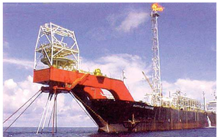
Hình 1. FPSO dạng neo một điểm neo
