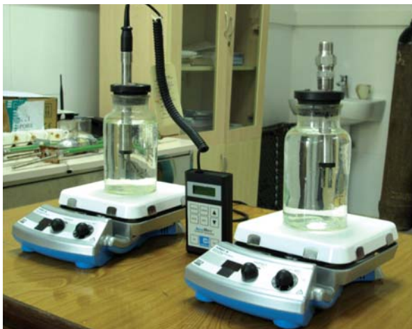
Hình 2. Thiết bị đánh giá ăn mòn bằng phương pháp đầu dò
